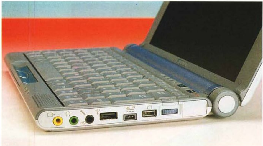
Sul lato destro, oltre alle connessioni audio/video e all'USB, si nota una rotella che, in congiunzione con un software specifico, permette di scorrere un menù di scorciatoie e impostazioni del Vaio, da confermare poi con una leggera pressione.
